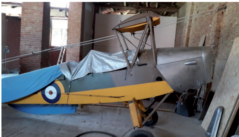
Sono ormai in dirittura finale i lavori di restauro del de Havilland DH-82a I-BANG. Nelle foto: l'aereo e due semiali.
