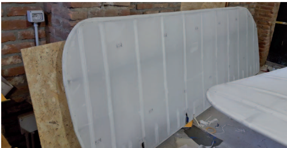
Sopra: una delle semiali appena intelata e pronta alla verniciatura. A sinistra: la cofanatura del motore.
