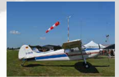
Il Cessna C170B D-ESCB, costruito nel 1957, è il più recente tra tutti i velivoli in condizioni di volo; il motore è un Continental O-300 da 145 hp
